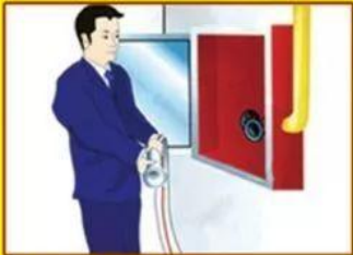
2、展开消防水带 Spred the water pipe
