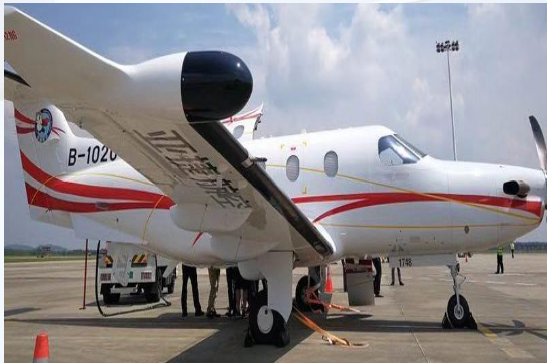
典型的机翼前缘除冰带
