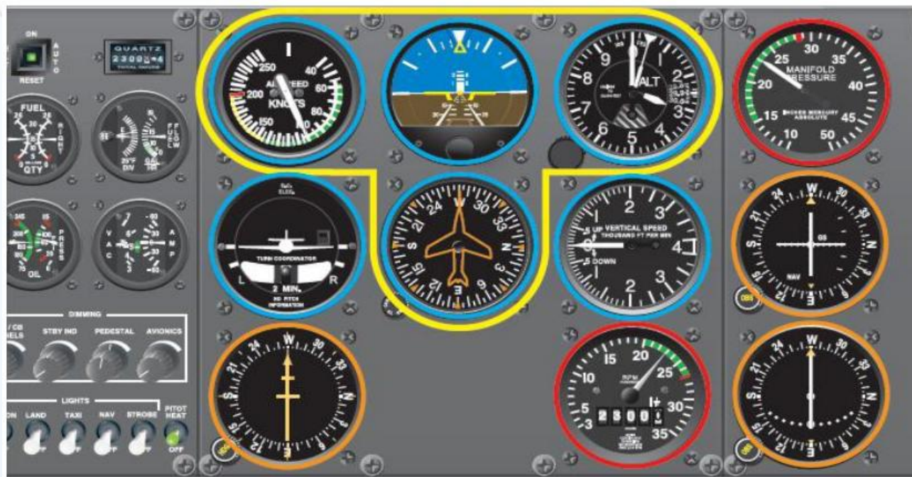
图 5-17 分离式仪表显示数据的基本“T”型格式
