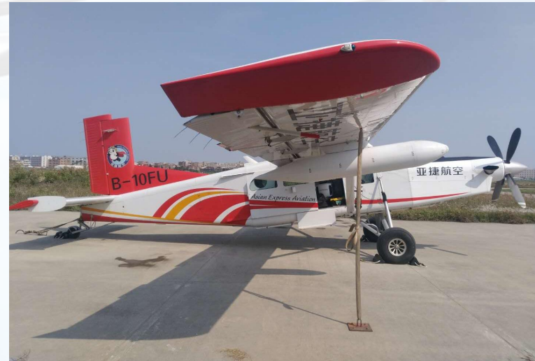
飞行器静止时，防止相对气流产生升力 而做的系留工作
