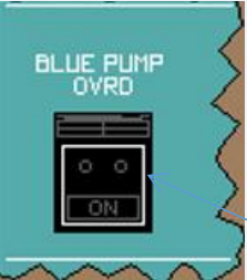
蓝系统电动泵超控电门
