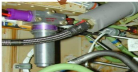
⑤电马达驱动泵壳体 回油滤组件
