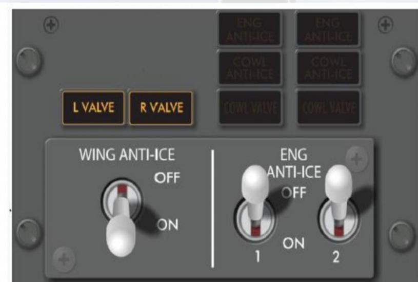
737MAX--大翼防冰电门无自动位
