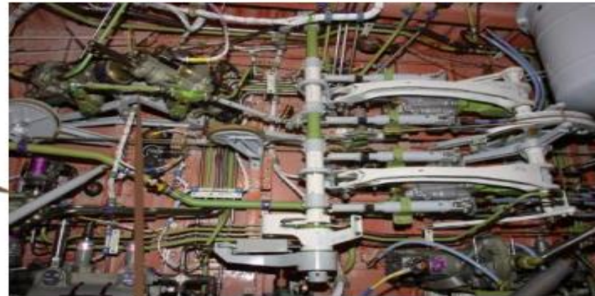
主起落架舱前壁板
