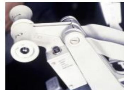
③TO/GA 电门和自动油门脱开按钮
