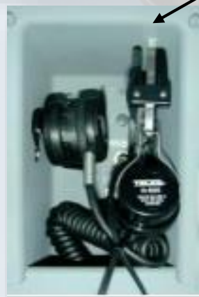
⑥插孔：观察员耳机/观察员面罩/观察员手持话筒
