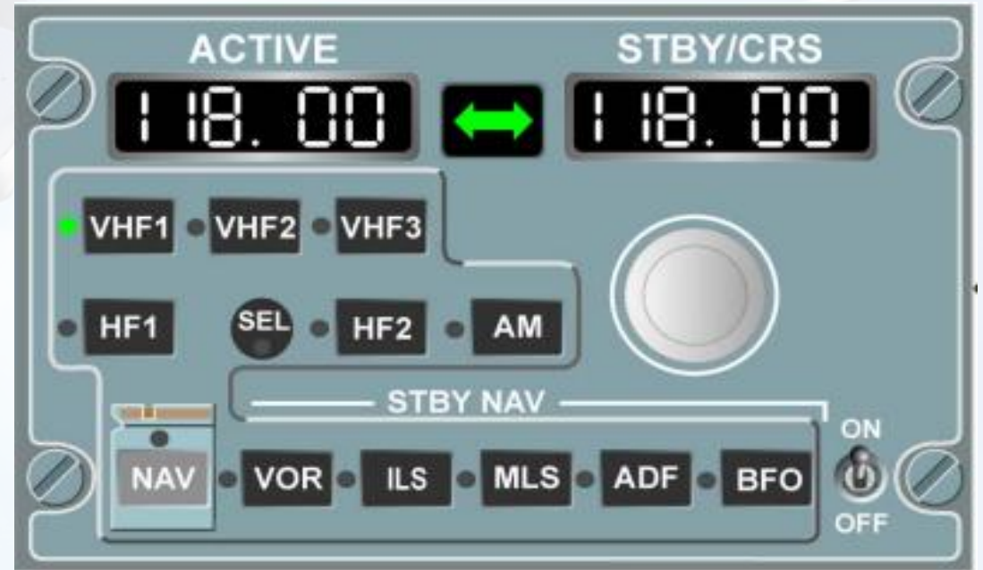
空客：无线电管理面板RMP Radio Management Panel
