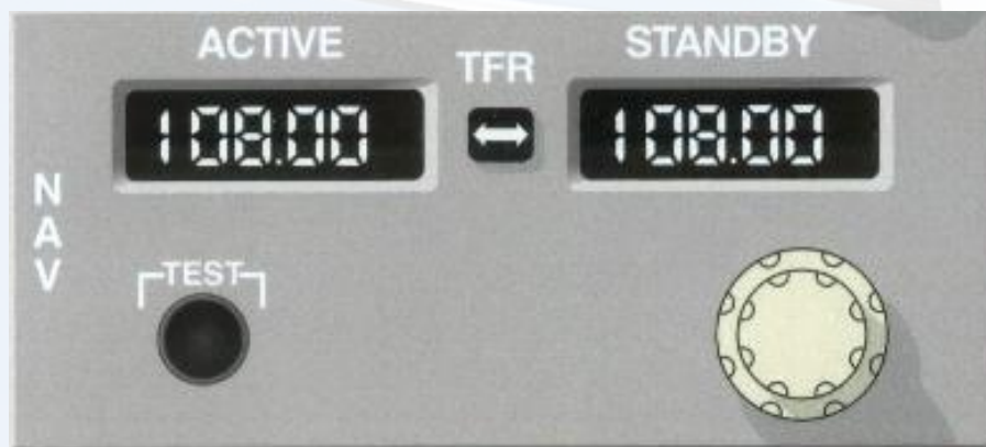
波音：导航控制面板
