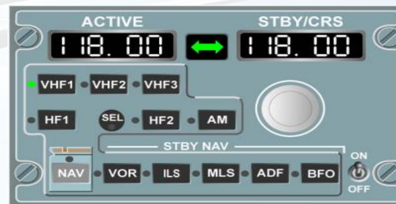
空客：无线电控制面板RMP
