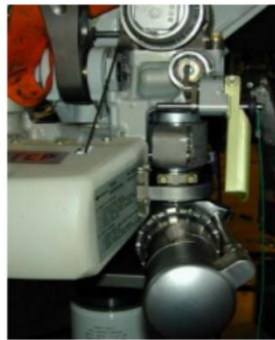
②前起转弯释压手柄 ③转弯作动筒
