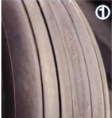
不正常磨损 (超压)
