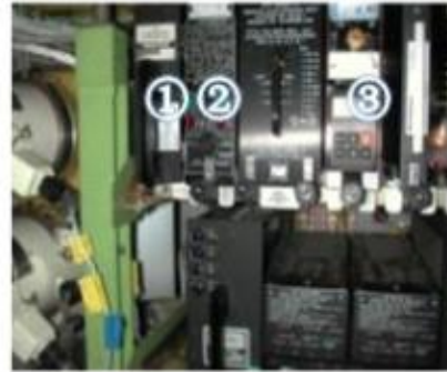
①空调附件组件 ②座舱温度控制器 ③座舱压力控制器
