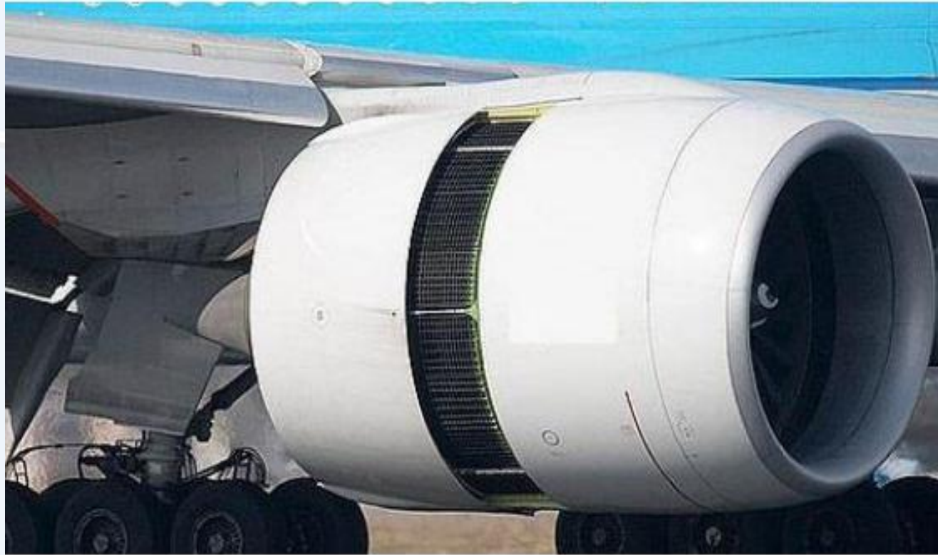
图 7-5 带平移罩的格栅式反推装置
