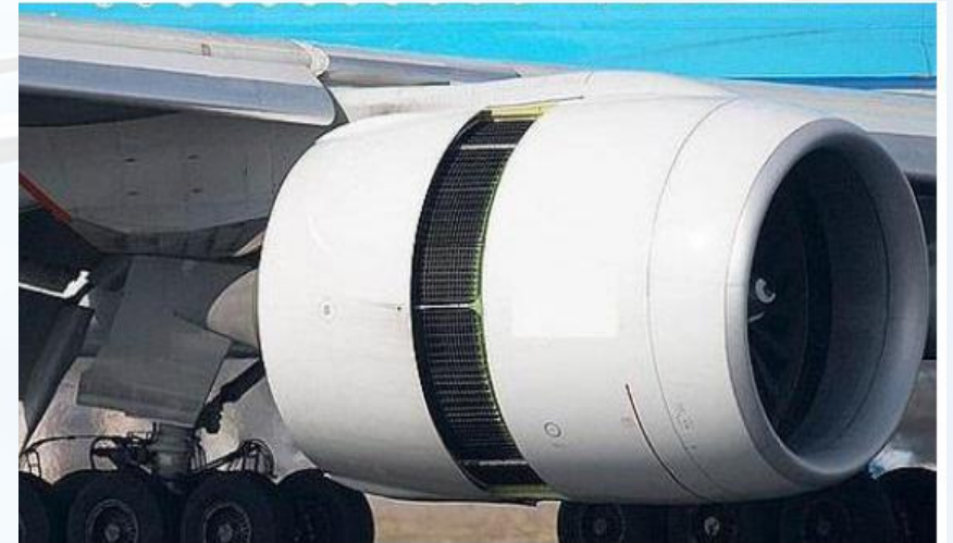
图 7-5 带平移罩的格栅式反推装置
