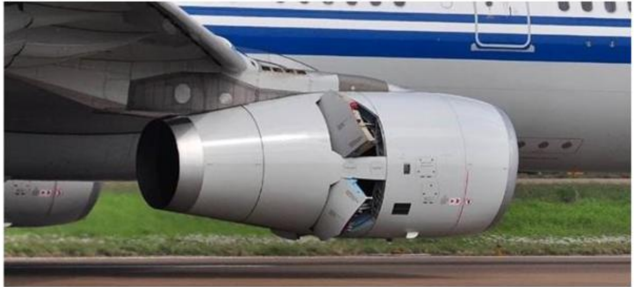
图 7-7 枢轴门式反推装置
