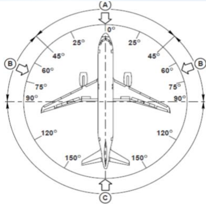
图 20-6 CFM56-5B 发动机地面运转时风速和风向的限制
