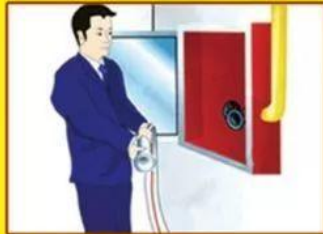
2、展开消防水带 Spred the water pipe
