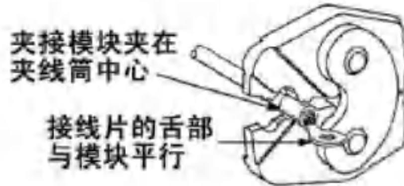
图 8-154 长柄夹接工具使用
