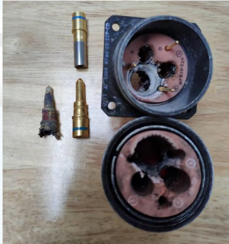
波音737-300飞机发电机馈线插头损伤案例
