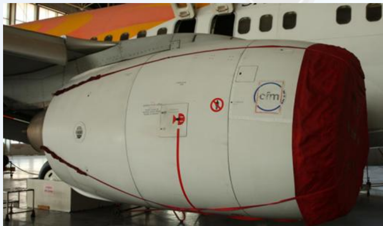
蒙布拉绳与反推整流罩后端通过卡环固定
