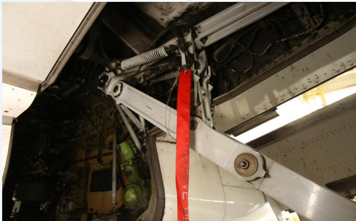
主起落架安全销安装
