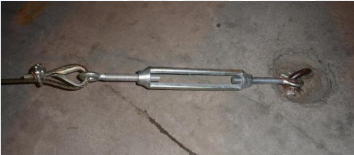
连接系留装置另一端到机坪地锚
