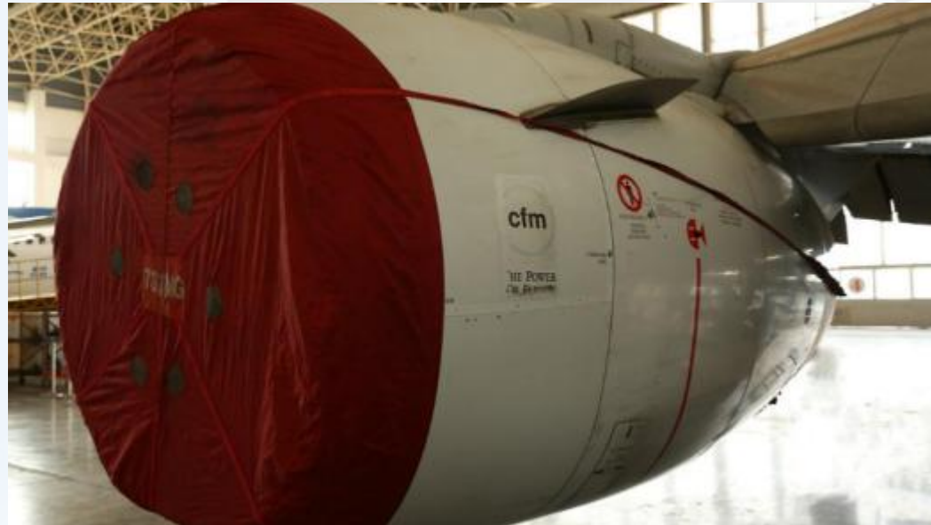
737-800型飞机发动机蒙布示例
