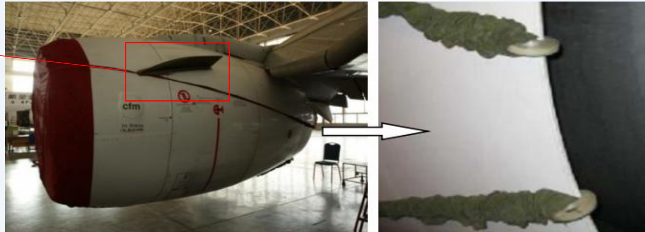
蒙布拉绳与反推整流罩后端通过卡环固定
