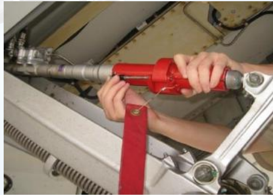
A320型飞机主起落架安全销的使用简图
