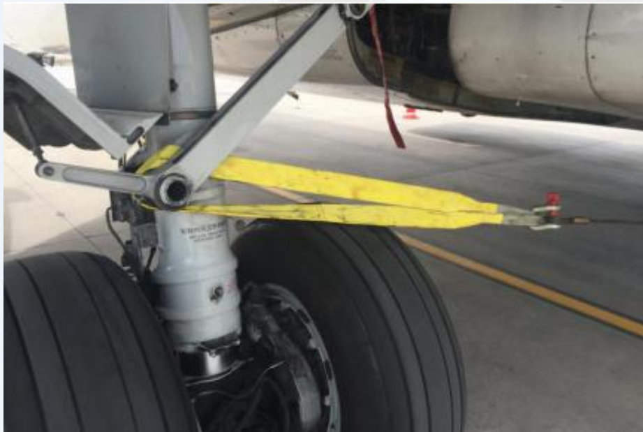
连接系留到主起落架简图
