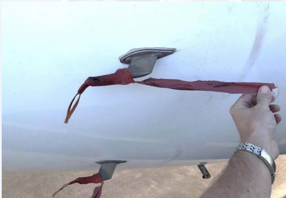
安装皮托管套
