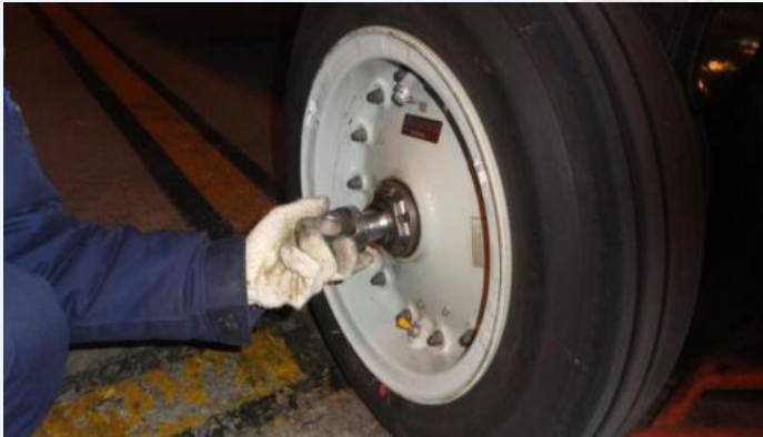
安装前起落架系留设备
