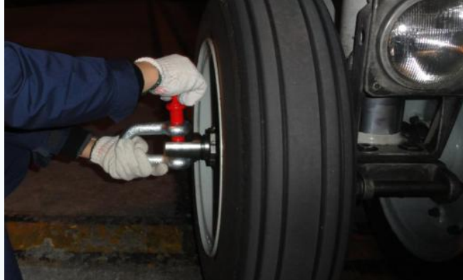
安装前起落架系留设备
