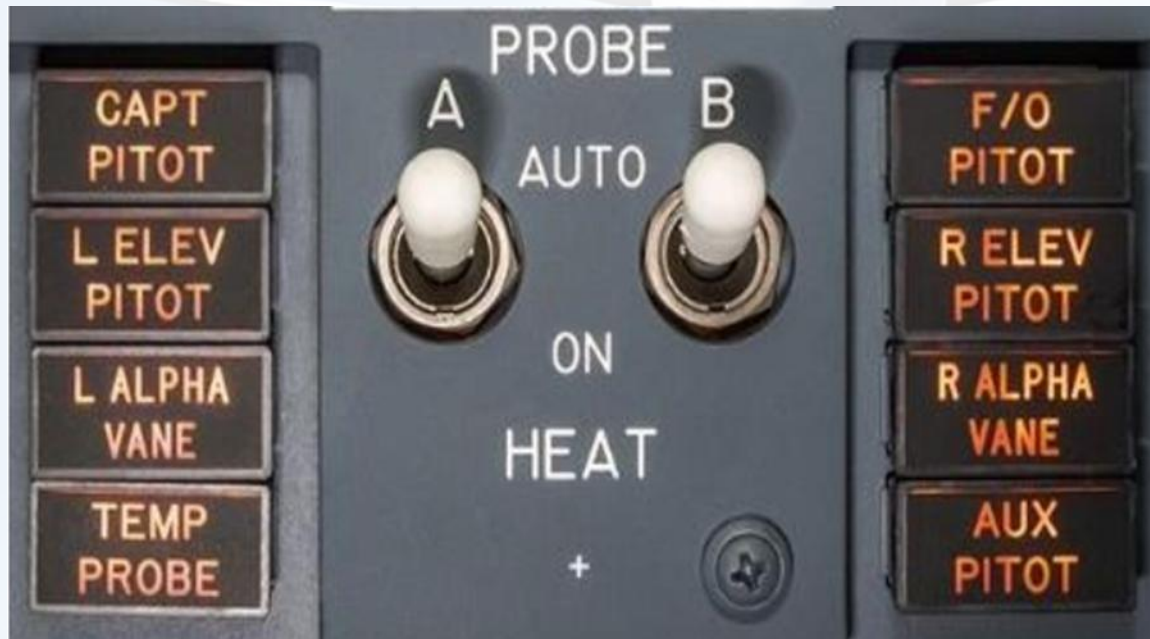
皮托管加温控制面板
