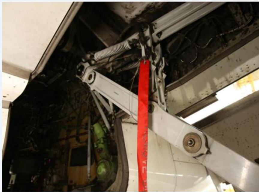
737-800型飞机起落架安全销的使用简图
