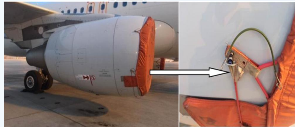
蒙布拉绳与风扇整流罩表面锁销孔固定
