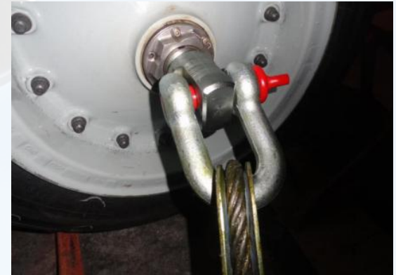
安装前起落架系留设备
