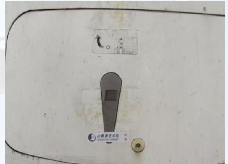
737-800 型飞机前设备舱贴封条示例
