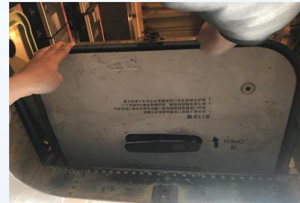
电子舱门沿滑轨推入锁定位
