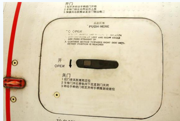
电子舱门关闭手柄复位
