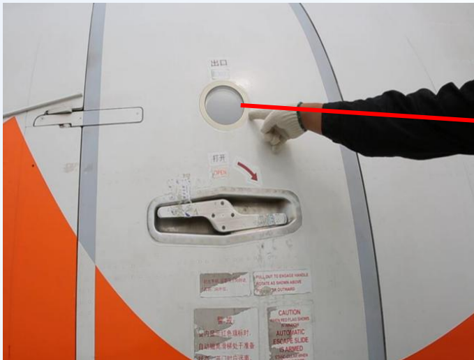
登机门外部检查确认警示带（应急滑梯）已解除预位
