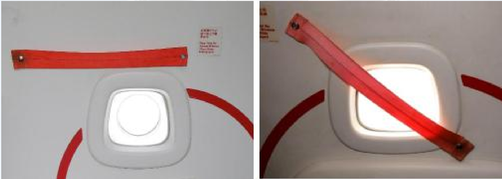
登机门内侧：左图登机门应急滑梯解除预位、右图登机门应急滑梯预位（禁止开门）
