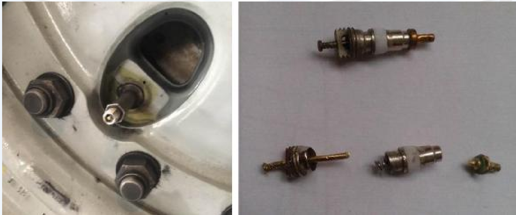
充气工具损伤气门芯
