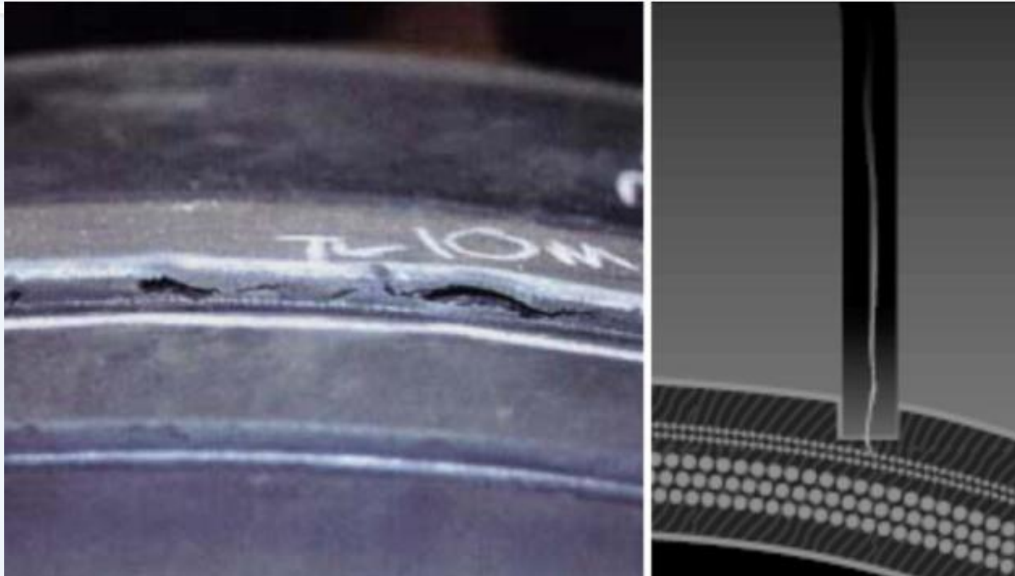
肋条底部损伤
