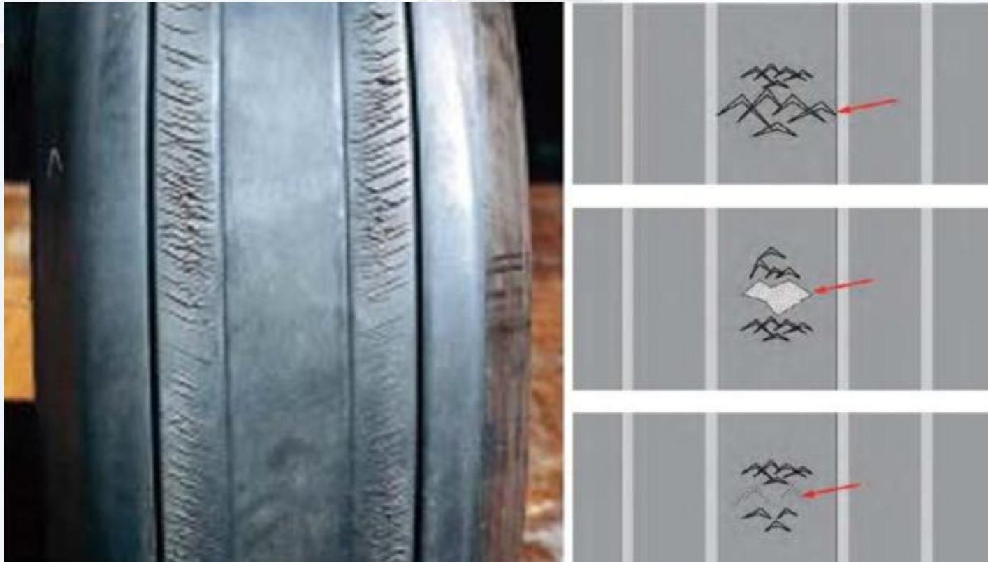
胎面人字形割伤损伤
