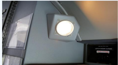
驾驶舱机长侧顶灯
