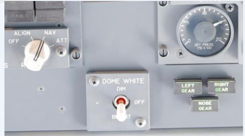
驾驶舱顶灯电门
