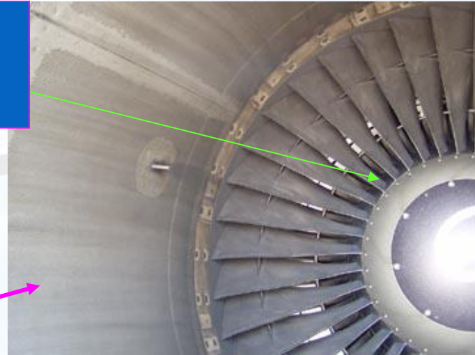
内涵道进口导向叶片 (在风扇叶片后面)
