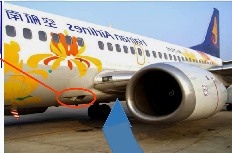
冲压出气口在主轮 舱前方的机腹底下
