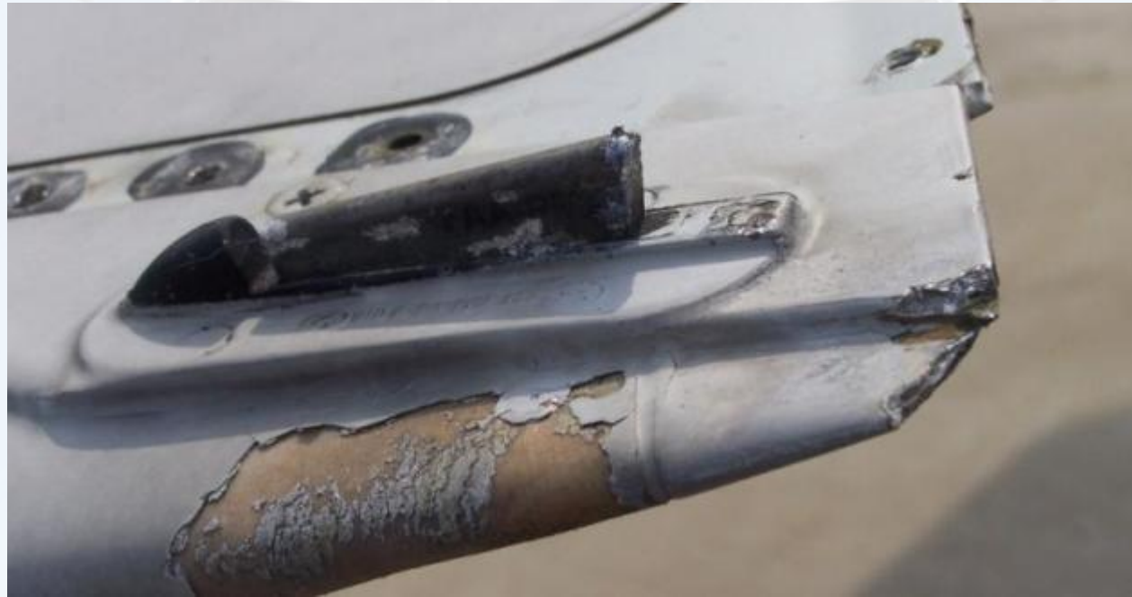
水平安定面后缘雷击 (放电刷烧蚀, 后缘导电条局部材料丢失)
